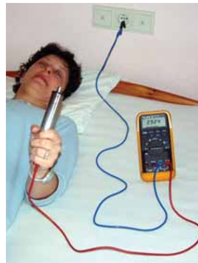
Bild 1: Körperspannungsmessung gegen Erdpotential mittels Digitalmultimeter
