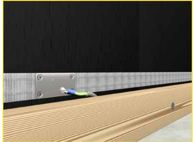
Abb.17: Anbringen des Erdungsbandes AEB 3,0 - Erdung mit EGP
