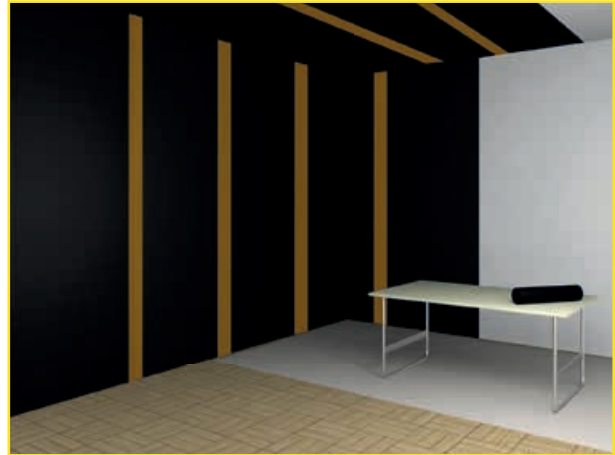
Abb.6: Tapezieren der einzelnen Bahnen mit Überlappung 5-10cm.
