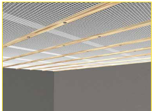
Abb.5: Fixe Befestigung der Bahnen mit Hilfe der Belattung - Entfernen der Hilfsnägel
