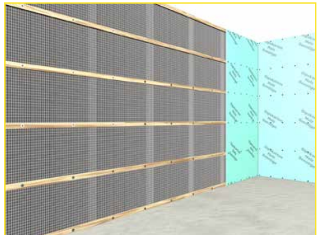
Abb.2: Fixe Befestigung der Bahnen mit Hilfe der Belattung - Entfernen der Hilfsbefestigung
