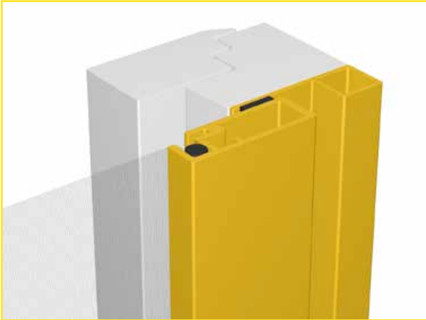
Abb.22: Metallprofil mit eingespannten Adamantan 003 vor Fensterrahmen
