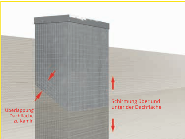
Abb.19: Optional Dachdurchdringung Kamin- Øx2 nach außen u. innen
