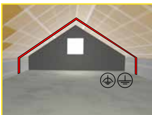
Abb.16a: Erdung Dachschräge mit EEB
