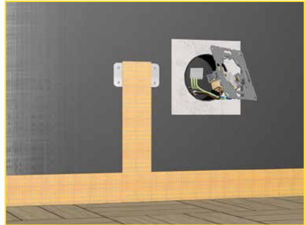
Abb. A2: Erdungsplatte neben Steckdose / Führung des Erdungsbandes / Einführen des Erdungsdrahtes in die Wanddose.
