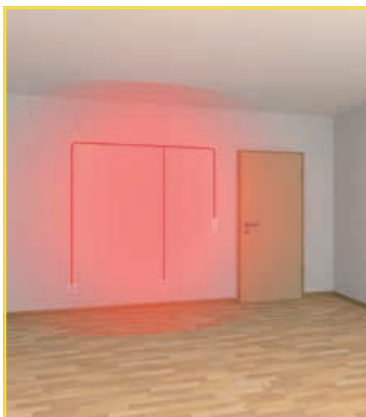
Vor Schirmung und ohne Erdung der Fläche oder Kabel.
